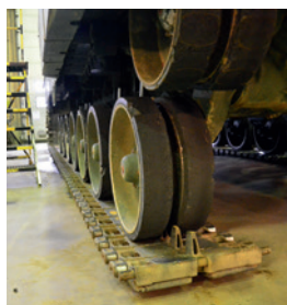
Bandaggregat till en leopardstridsvagn under pågående reparation.
