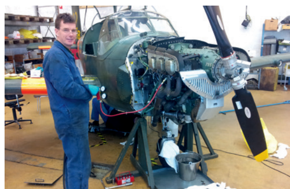
Michael Åström, en av grundarna till personalflygklubbarna och F 3 VFK tillika chefstekniker och pilot, utför läckprov.
