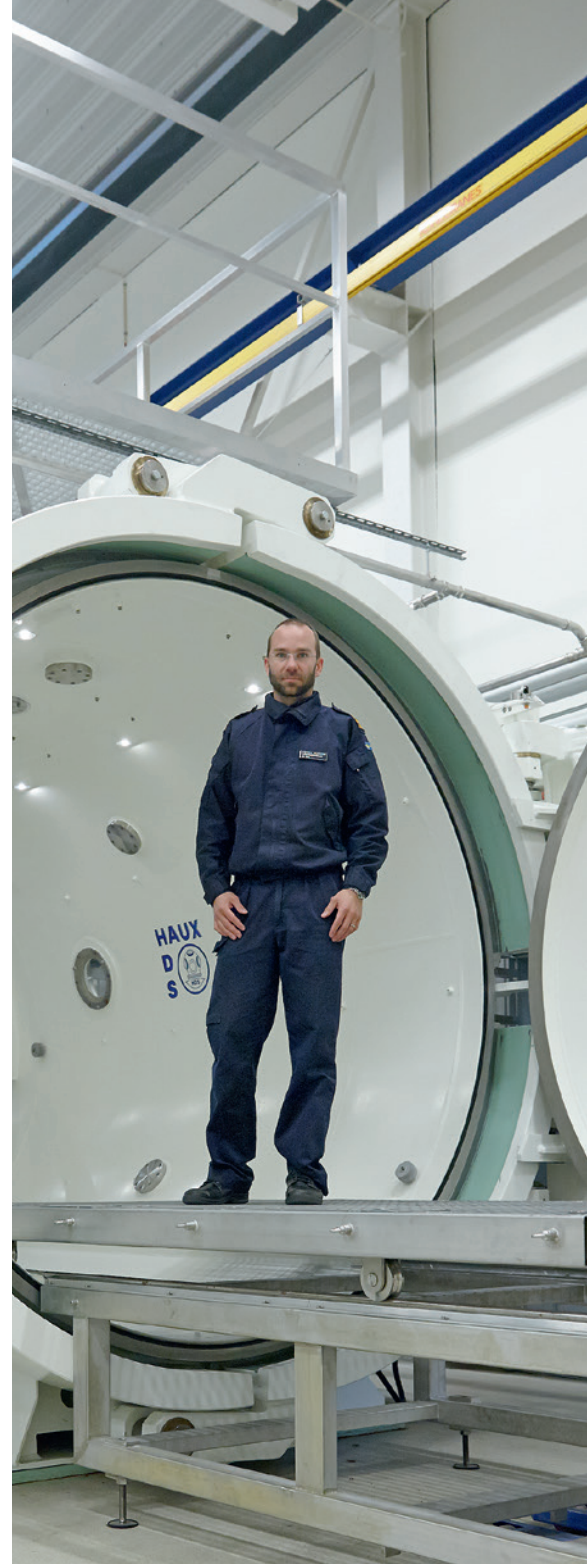
Tryckkammaren är helt horisontellt byggd och indelad i två delar, en bostadsdel och en försöksdel.
