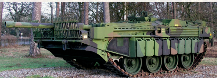
Strv 103 C fullutrustad med en vikt av 42,5 ton inkl. galler mot RSV i fronten och bränsledunkar som extra skydd i sida.
