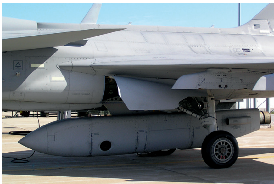
Spaningskapsel SPK 39, hängd på 39C 39256, inför det första flygpasset på förband, i maj 2007. Fyra år senare gjorde detta spaningssystem god nytta över Libyen. Foto: Emil Lindberg
