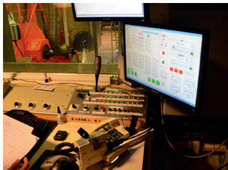
Övervakning av motortester sker i ett angränsande rum med bra arbetsmiljö.
