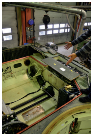
Magnus visar upp det tomma motorutrymmet på en leopardstridsvagn.
